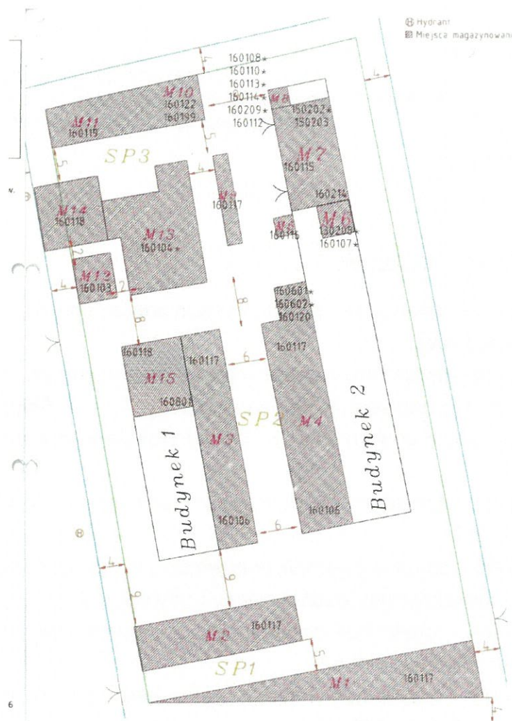
Rys.1. Schemat rozmieszczenia miejsc magazynowania odpadów.
